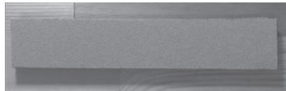
2. На пластину для шкурения наклеивают с обеих сторон полоски наждачной бумаги, вырезанной по контуру этой пластины и дают просохнуть. Бруск готов к работе!
